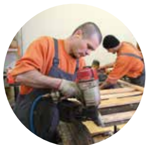
Pomocí ručního vzduchového nářadí
