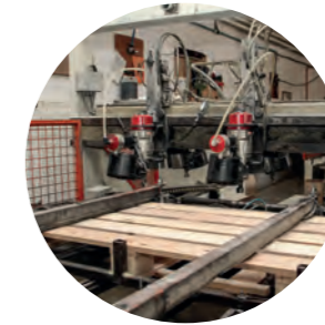
Mittels halbautomatischen Palettenfertigungsmaschinen von ATICA
